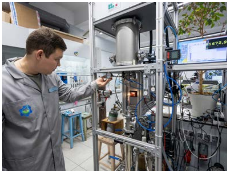
Получение наночастиц в установке индукционной потоковой левитации, м.н.с. Марков Артем
