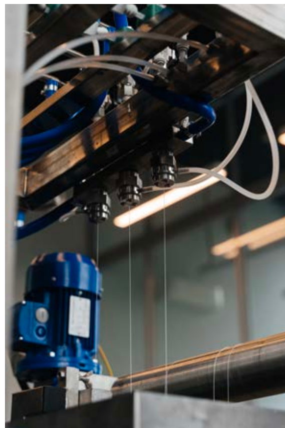
Экструзия полволоконных мембран на «Шагалочке»
