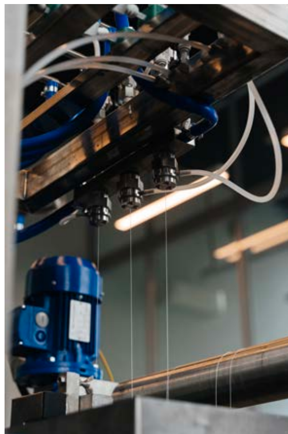
Экструзия полволоконных мембран на «Шагалочке»
