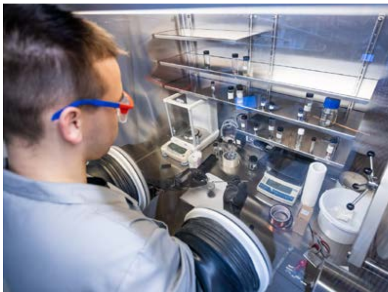
Пробоподготовка проводящих наночастиц для изготовления гибких OLED-устройств, аспирант Докин Егор
