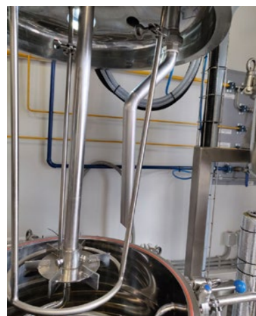
Газораспределительное устройство на поднятой крышке нержавеющей реактора 100 л
