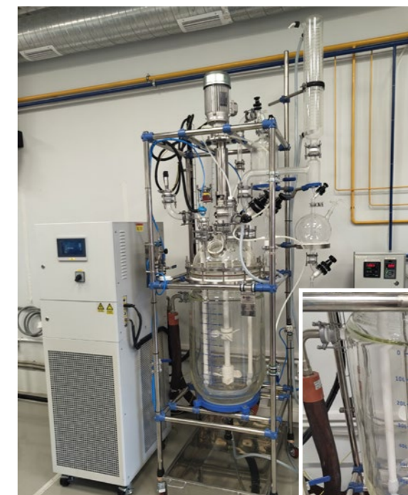
Реакторная установка на основе реактора 100 л из боросиликатного стекла 3.3 со стеклянной обвязкой и термостатом
