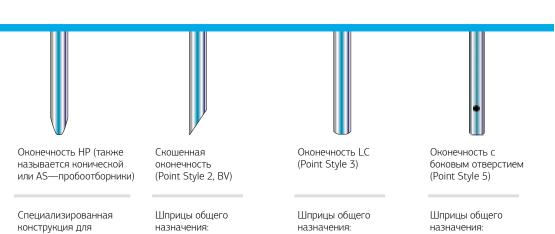
Специализированная конструкция для пробоотборников Agilent, меньше повреждает мембрану, обеспечивает повышение эффективности и надежности.
